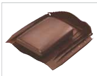
KG 9854 455 mm x 440 mm x 91 mm (sans conduit de ventilation) Largeur de couverture : 395 mm x 360 mm
